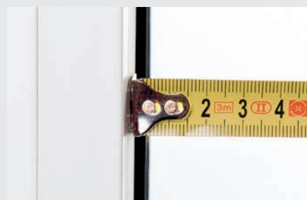
Gummidichtung schmaler als 5 mm
