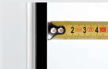
Gummidichtung breiter als 5 mm
